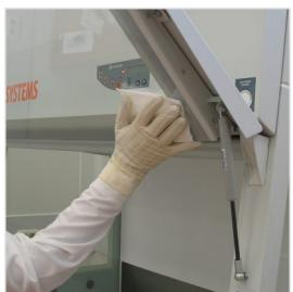
Лицевое стекло – «триплекс». При разбивании не образует травмоопасных осколков, а покрывается трещинами, сохраняя форму. Повреждение фронтального стекла не влечет за собой нарушения воздушных потоков и не снижает защитные свойства бокса.
